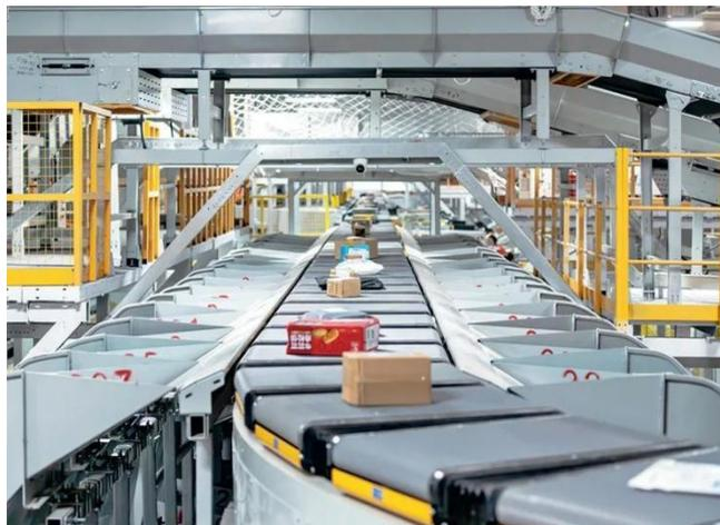
图为 2024 年 4 月 23 日，申通湖南长沙转运中心电磁驱动超高速三层交叉带正在分拣快件。国家邮政局供图 王馨仪/摄
